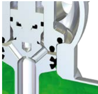
Bewegung unterer Teller Untere Schiene geschlossen Leckageraum offen -> kein Produktverlust
