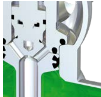
Bewegung unterer Teller Untere Schiene geschlossen Leckageraum geschlossen
